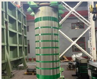
PRJ-01 Lõi máy biến áp siêu cao áp 330 kV
