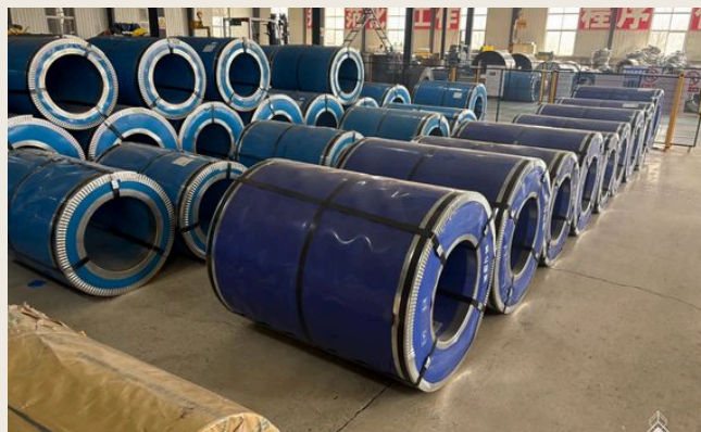
FIG. 03 STOCK COURANT DE CRGO — ~3 000 t, PLUSIEURS NUANCES
