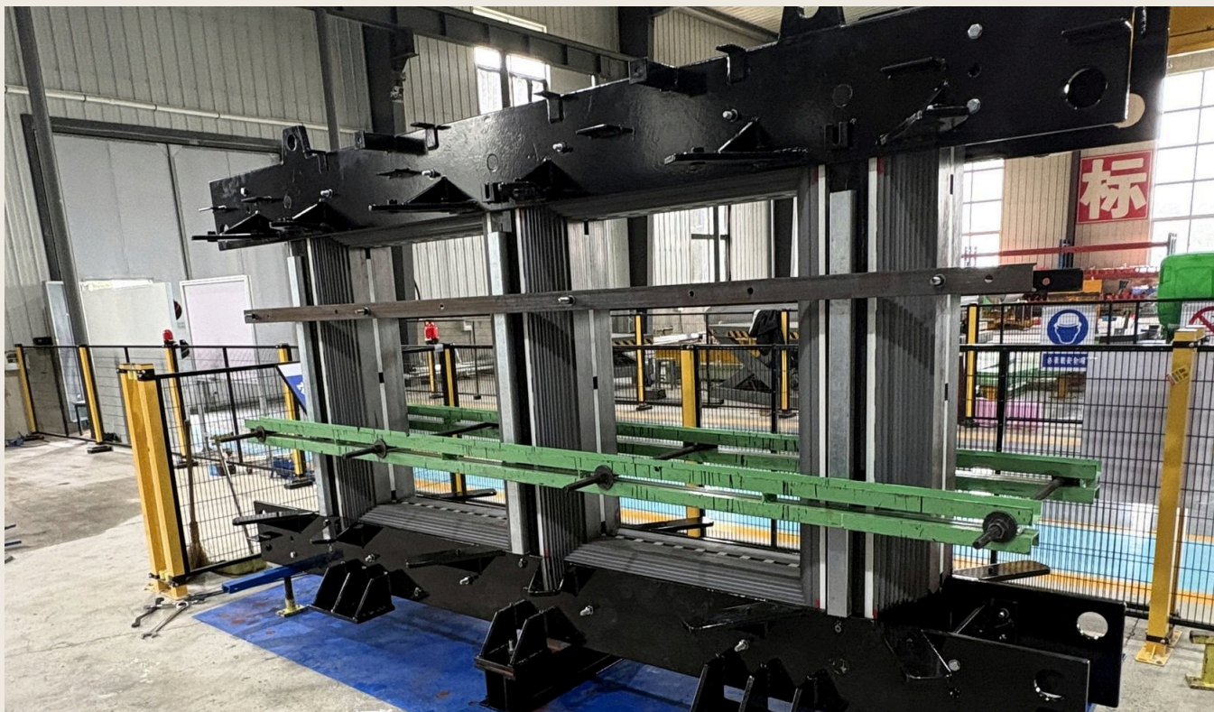
HÌNH 11 LỖI THÉP MÁY BIẾN ÁP KHÔ CÓ KẾT CẤU KẸP — VỊ TRÍ TIẾP GIÁP LẮP RÁP
