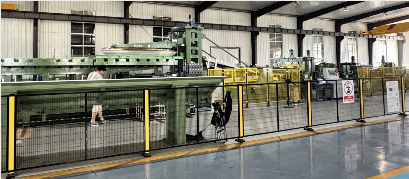
HÌNH 05 DÂY CHUYỀN CẮT TỰ ĐỘNG THEO CHIỀU DÀI — KHU SẢN XUẤT CÓ RÀO BẢO VỆ
