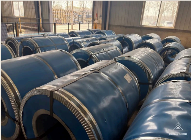
HÌNH 13 CUỘN CRGO — ĐƯỢC BẢO VỆ TRONG KHO VẬT LIỆU
