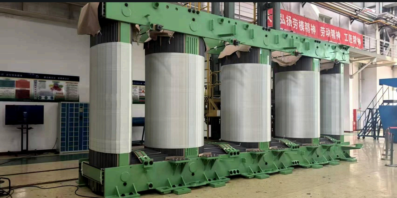
HÌNH 12 LỖI THÉP MÁY BIẾN ÁP NĂM TRỤ CỖ LỚN CÓ KHUNG KẸP — LẮP RÁP TẠI XƯỞNG
