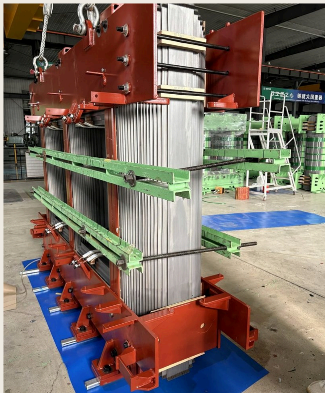
HÌNH 10 LỖI THÉP HOÀN THIÊN TRÊN BỆ LẮP RÁP
