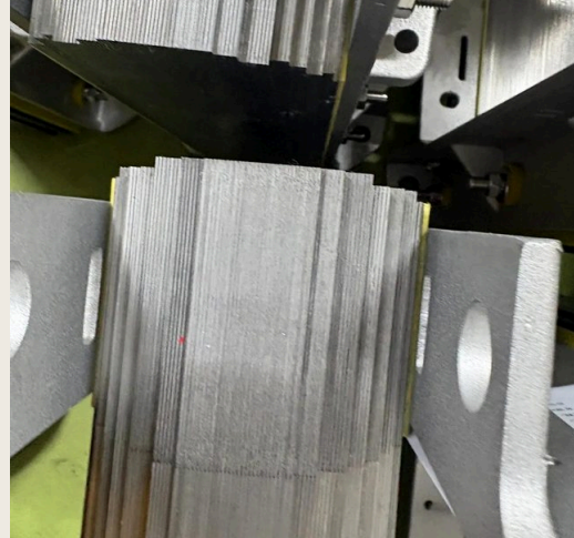
ŞEK. 16 KADEMELİ BACAK KESİTİ — PAKET KENARLARI MONTAJDA KONTROL EDİLİR
