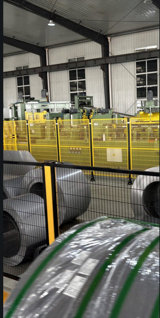
ŞEK. 07 DİLME HATTI — ÜRETİMDEKİ ŞERİT RULOLAR
