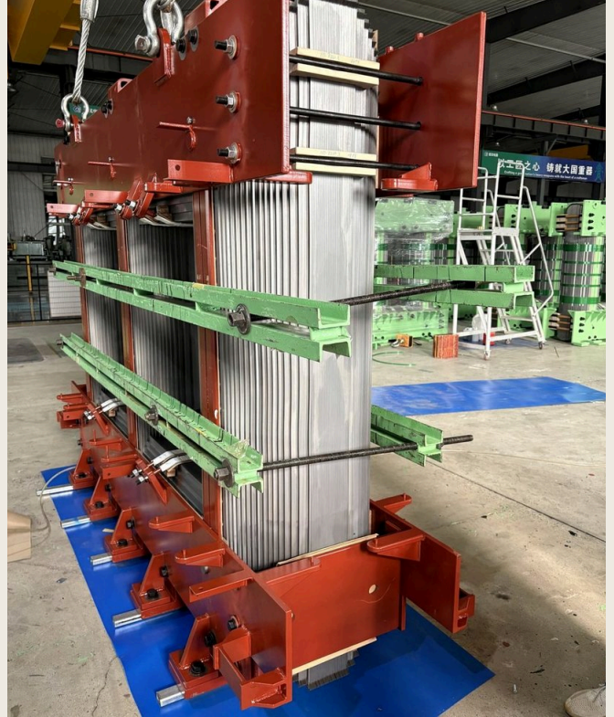
ŞEK. 10 MONTAJ PLATFORMUNDA TAMAMLANMIŞ NÜVE
