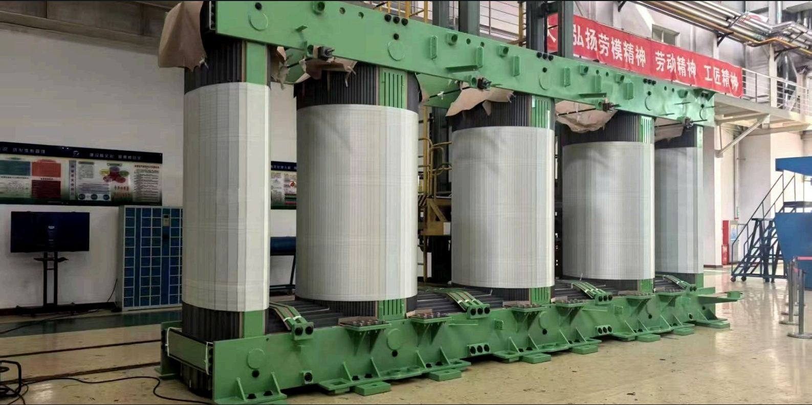
ŞEK. 12 SIKIŞTIRMA ÇERÇEVELİ BÜYÜK BEŞ BACAKLI TRANSFORMATÖR NÜVESİ — ATÖLYEDE MONTAJ
