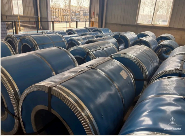
ŞEK. 13 CRGO RULOLARI — MALZEME DEPOSUNDA KORUMA ALTINDA
