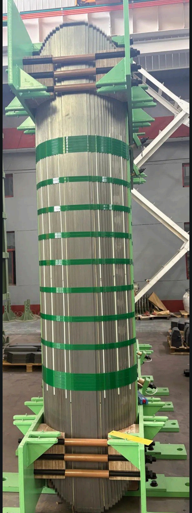
ŞEK. 15 ATÖLYEDE 330 kV TRANSFORMATÖR NÜVESİ
