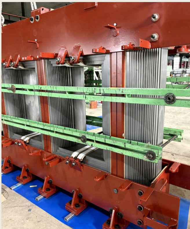
FIG. 09 NUCLEO ASSEMBLATO E SERRATO — DETTAGLIO DI COLONNA E GIOGO
