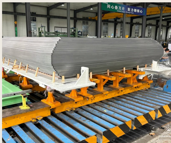
FIG. 04 FASI 04-05: COLONNA IMPILATA SULLA CULLA DI ASSEMBLAGGIO
