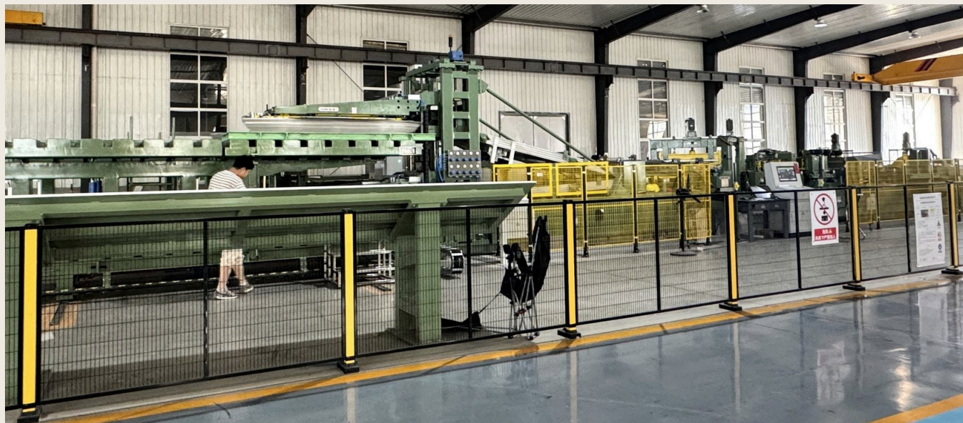
FIG. 05 LINEA AUTOMATICA DI TAGLIO A MISURA: AREA PRODUTTIVA PROTETTA
