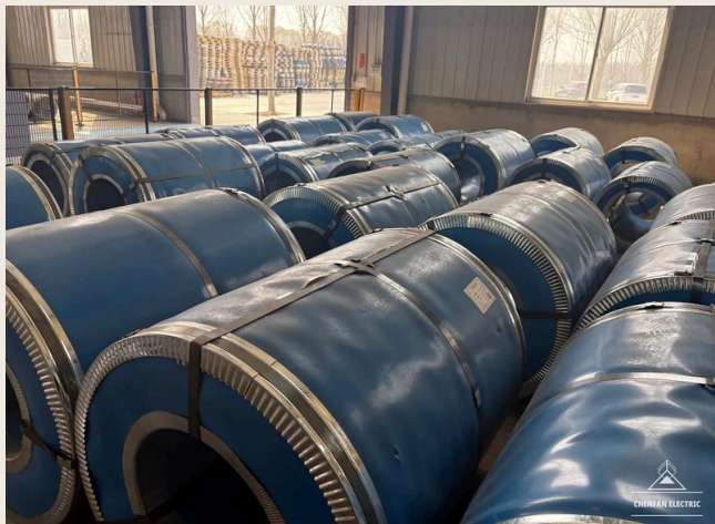
GBR. 13 GULUNGAN CRGO — TERLINDUNGI DI GUDANG MATERIAL
