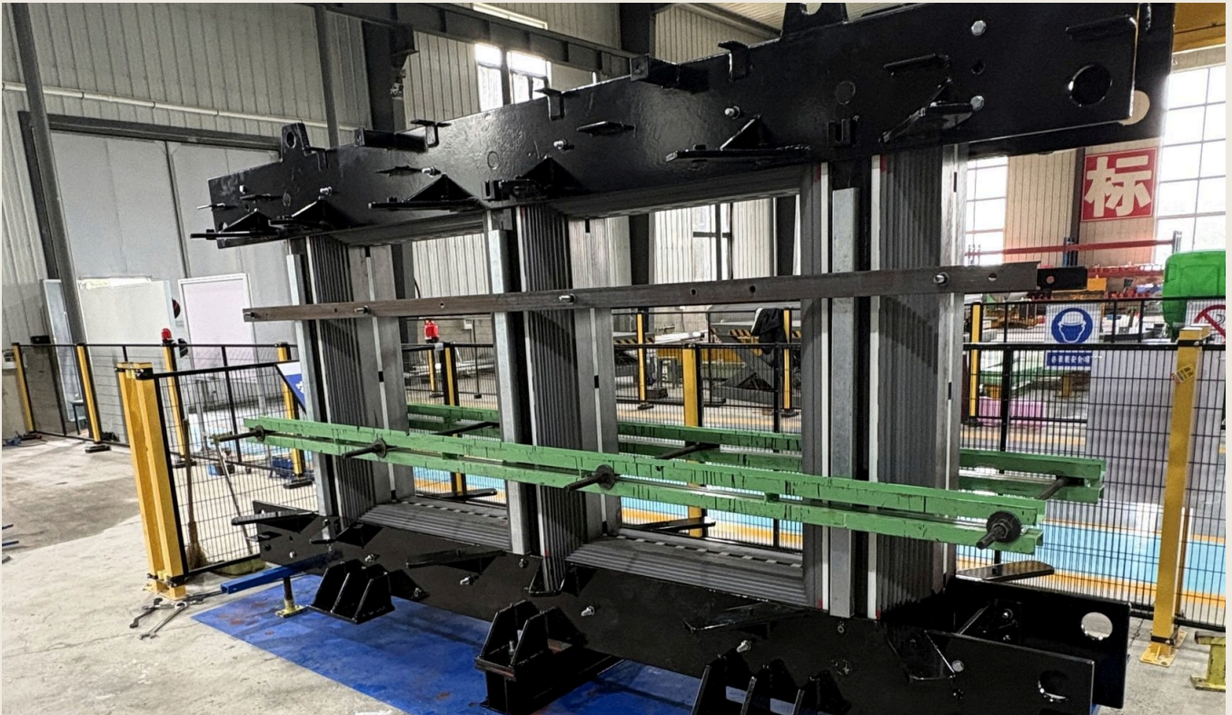
GBR. 11 INTI KERING DENGAN STRUKTUR PENJEPIT — ANTARMUKA PERAKITAN
