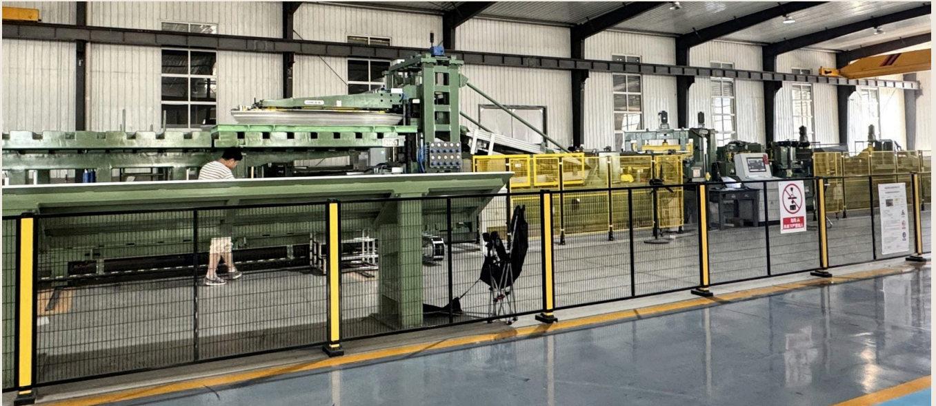
GBR. 05 LINI PEMOTONGAN OTOMATIS SESUAI PANJANG — AREA PRODUKSI BERPENGAMAN
