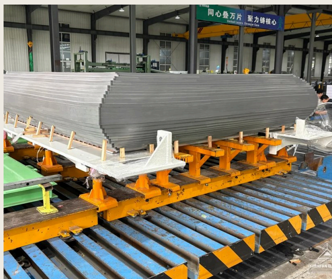
FIG. 04 ETAPAS 04-05: COLUMNA APILADA SOBRE LA CUNA DE MONTAJE
