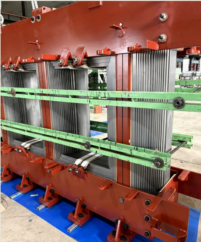
FIG. 09 NÚCLEO ENSAMBLADO Y SUJETO — DETALLE DE COLUMNA Y YUGO
