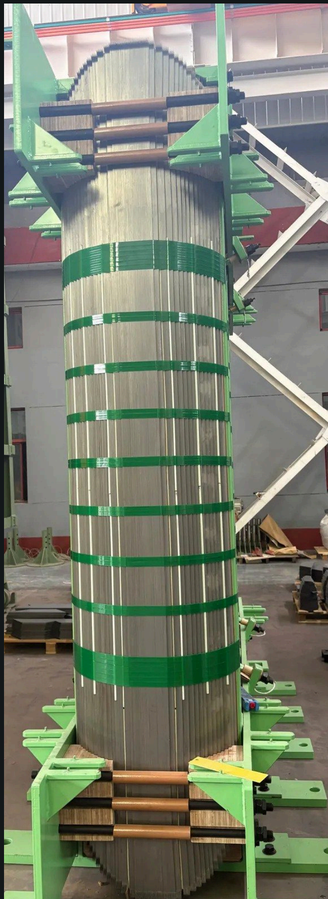
FIG. 15 NÚCLEO PARA TRANSFORMADOR DE 330 kV EN TALLER
