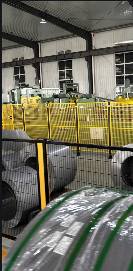
FIG. 07 LÍNEA DE CORTE LONGITUDINAL: BOBINAS DE FLEJE EN PRODUCCIÓN
