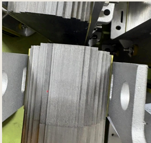
FIG. 16 SECCIÓN DE COLUMNA ESCALONADA — BORDES DE PAQUETES REVISADOS EN MONTAJE
