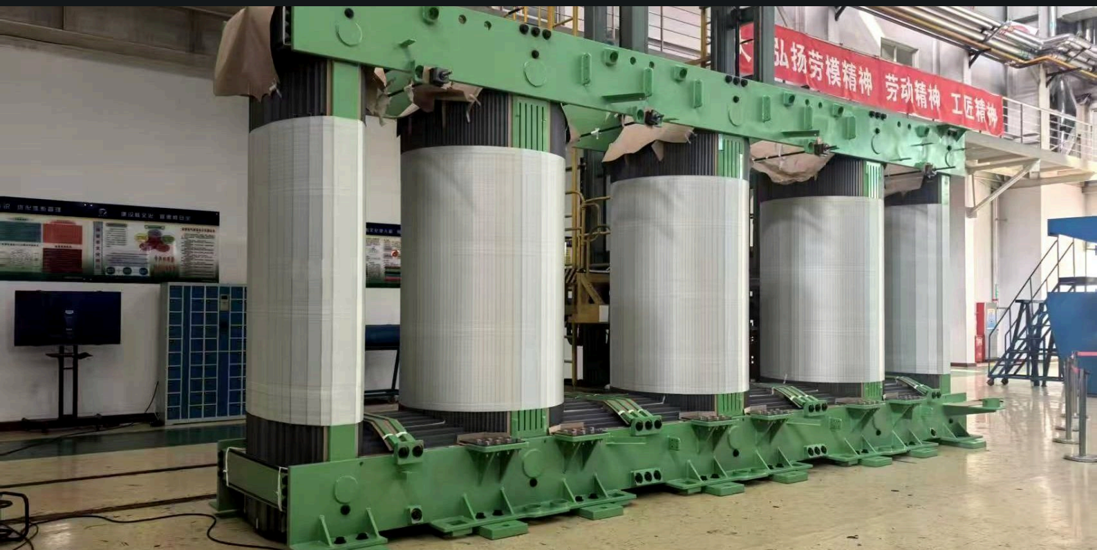
FIG. 12 NÚCLEO GRANDE DE CINCO COLUMNAS CON BASTIDORES DE APRIETE — ENSAMBLADO EN TALLER
