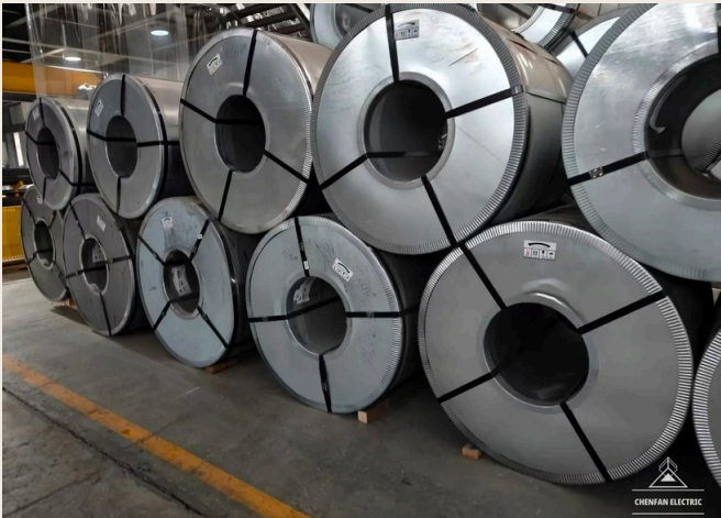
FIG. 06 BOBINAS MADRE CRGO EN EL ALMACÉN
