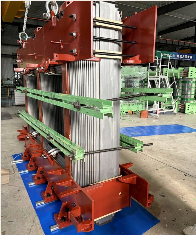
FIG. 10 NÚCLEO TERMINADO EN LA PLATAFORMA DE MONTAJE
