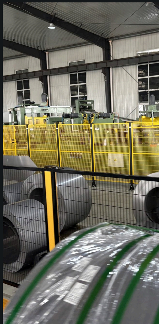
ABB. 07 LÄNGSTEILANLAGE - SPALTBÄNDER IN PRODUKTION
