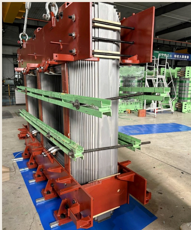
ABB. 10 FERTIGER KERN AUF DER MONTAGEPLATTFORM
