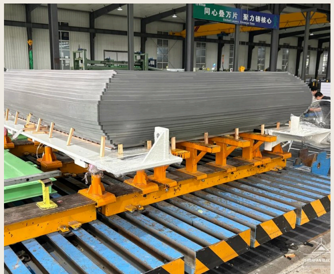
ABB. 04 STUFE 04-05 – GESTAPELTER SCHENKEL AUF DER MONTAGEVORRICHTUNG
