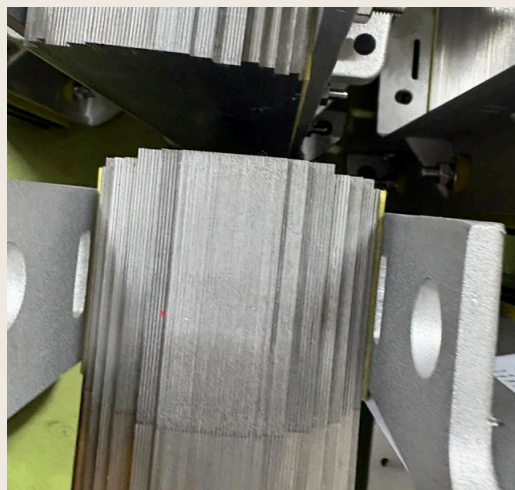
ABB. 16 GESTUFTER SCHENKELQUERSCHNITT - PAKETKANTEN BEI DER MONTAGE GEPRÜFT
