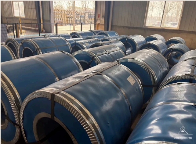
ABB. 13 CRGO-COILS – GESCHÜTZT IM MATERIALLAGER
