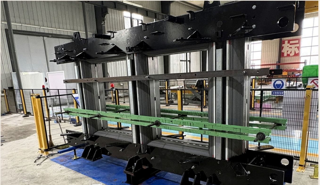
ABB. 11 TROCKENTRANSFORMATORKERN MIT VERSPANNUNG - MONTAGESCHNITTSTELLE
