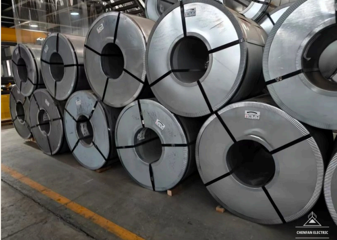
ABB. 06 CRGO-MASTERCOILS IM MATERIALLAGER
