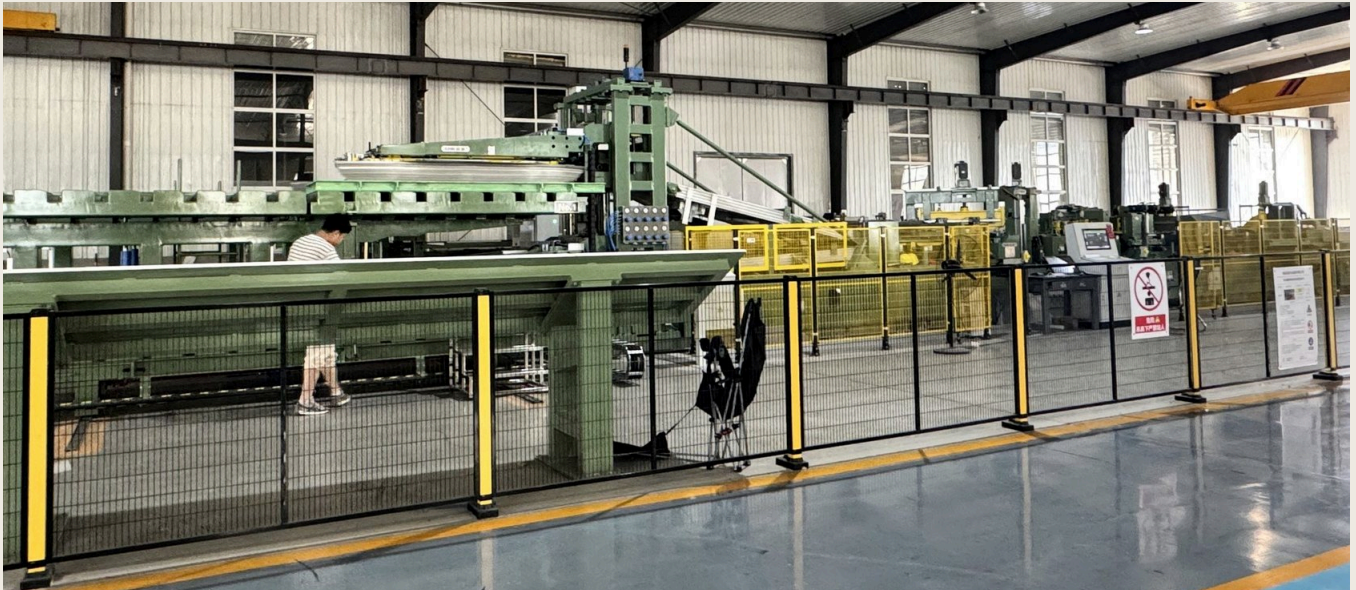
ABB. 05 AUTOMATISCHE ABLÄNGLINIE – ABGESICHERTER PRODUKTIONSBEREICH
