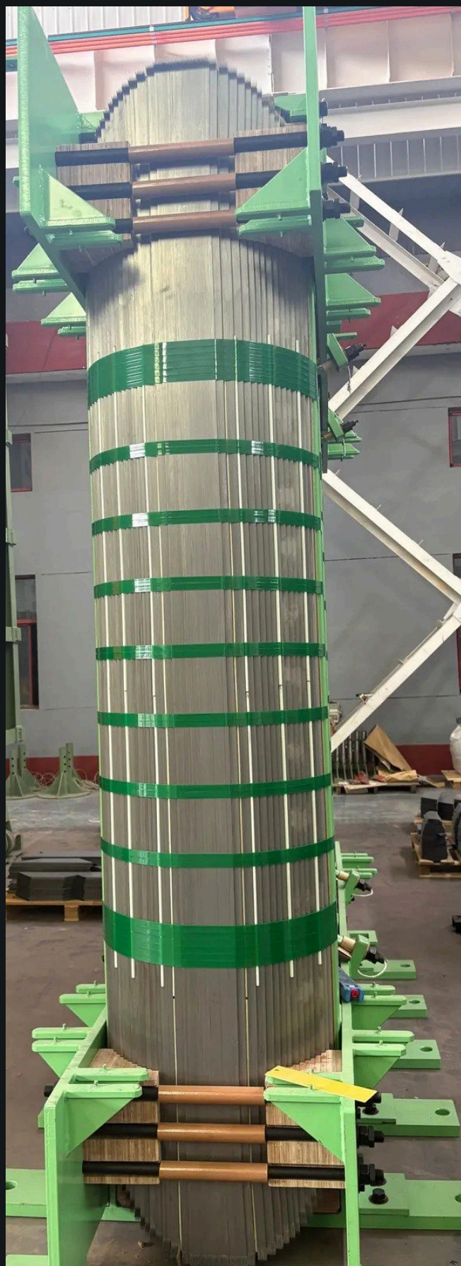
ABB. 15 330-KV-TRANSFORMATORKERN IN DER WERKHALLE
